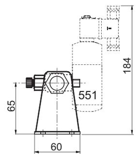
Esta disposição de montagem permite que as válvulas sejam montadas nas posições abaixo.
