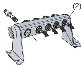
Trilha de alimentação com válvulas de isolamento para a série 551
