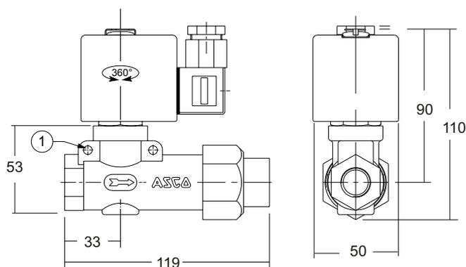
① 2 orifícios de fixação Ø 5,1 mm, entre-furos 38 mm.
